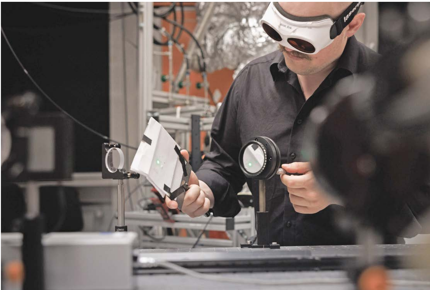
Erik Wüst, Doktorand bei Prof. Brezinsek, beim Justieren der Optiken für die Pikosekundenlaser-Plasmaspektroskopie.
